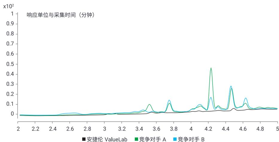
PTFE-Q (亲水) 的 LCMS 测试结果，ValueLab 过滤器溶出物质极低
