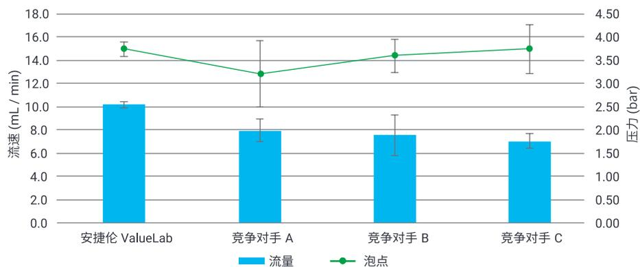
尼龙材质 0.2  $\mu\text{m}$  孔径，13 mm 直径的流速，ValueLab 的高流速保证了样品处理的通量，高泡点保证了滤膜孔径的均一性
