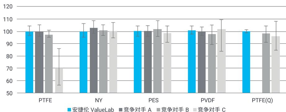
选用 0.45  $\mu\text{m}$  孔径的膜，过滤 0.5  $\mu\text{m}$  的颗粒胶体，测试其过滤的效率，ValueLab 过滤产品的过滤效率均在 99.5% 以上，并且重现性极好。(RSD 在 5% 以下，n=6)
